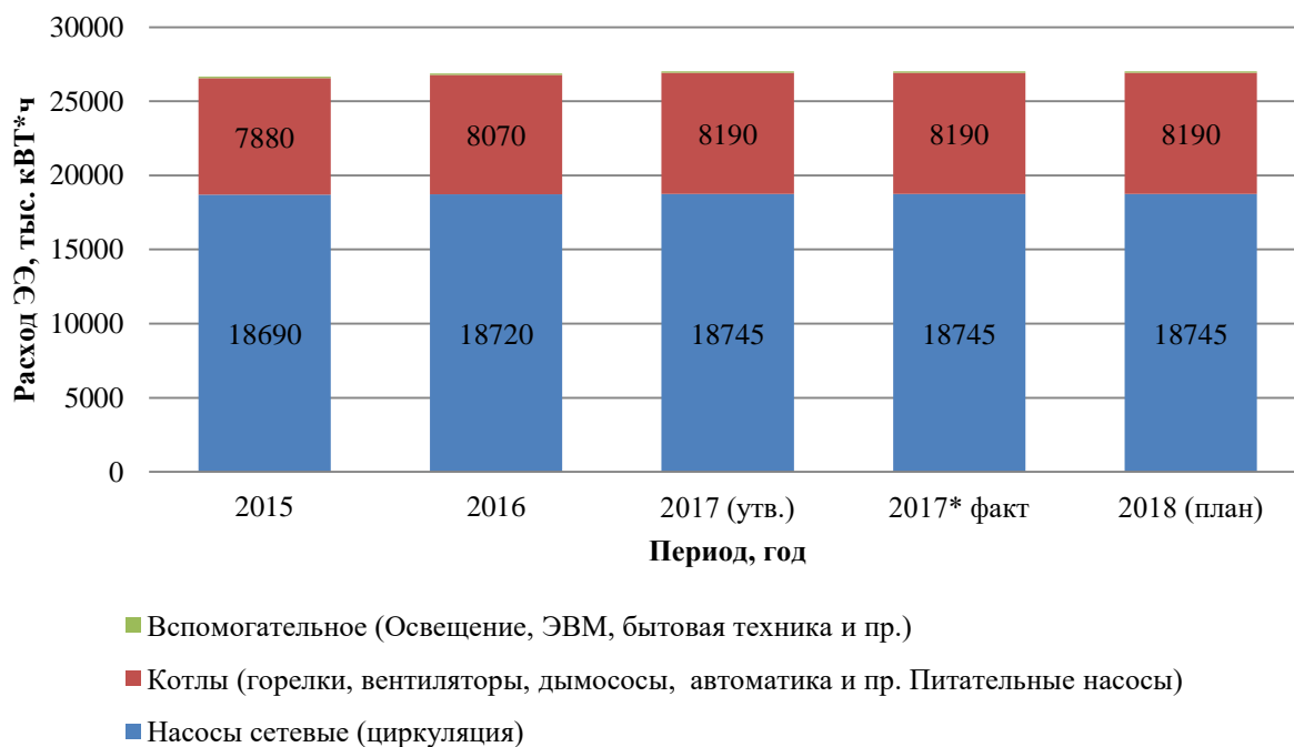
Рисунок 8 - Баланс потребления электрической энергии на Городской котельной МП «Теплоснабжение» по группам оборудования
