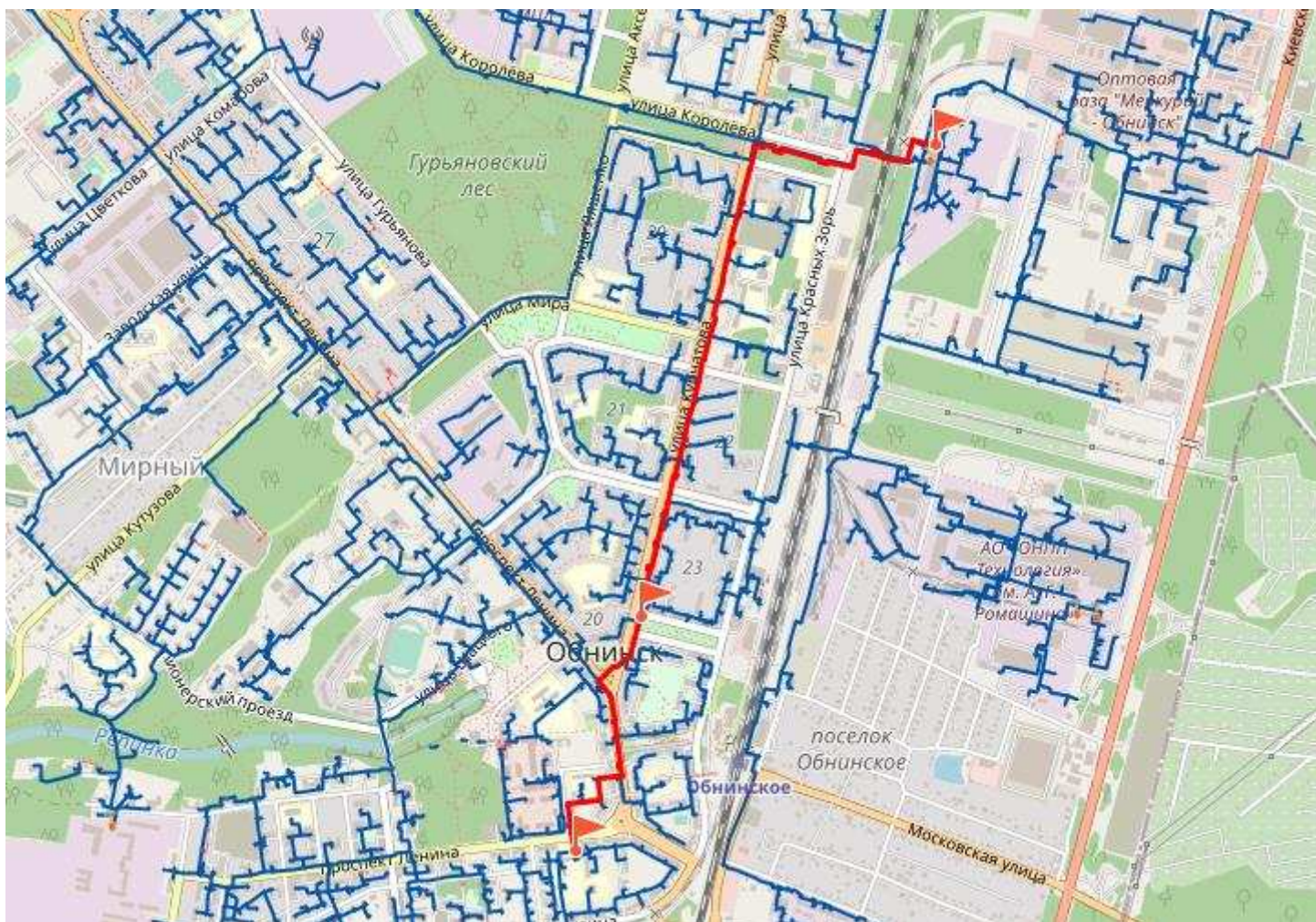
Рисунок 4 - Путь для построения пьезометрического графика магистрального вывода от котельной АО «РИР» (2 очередь) до ТК-6
